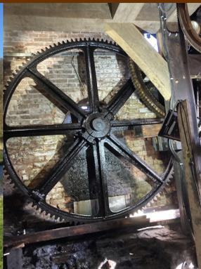
Plusieurs roues de différentes tailles fonctionnent entre elles grâce aux alluchons, des dents en bois fixées sur une couronne métallique pour créer un engrenage.
